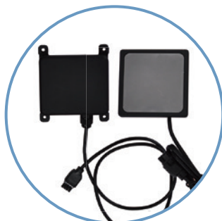
Радар обхода препятствий и радар слежения за рельефом местности
